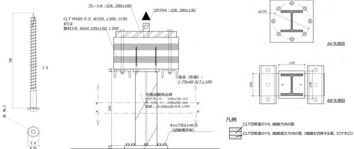
※ 特にCLT表層の表層のラミナ継目目地とビスの打ち込み位置が揃ってしまっているもの。試験体図
