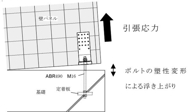
図 1-1 壁脚部のロッキング挙動
