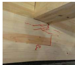
No1下側CLTの曲げ破壊
