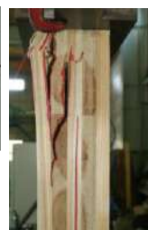
圧縮破壊とラミナの座屈に伴う割れ
