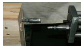
LSB破断、LSB抜け
