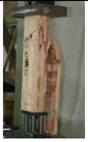
圧縮破壊とラミナの座屈に伴う割れ、剥落
