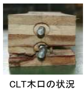
圧縮破壊とラミナの座屈に伴う割れ、剥落
