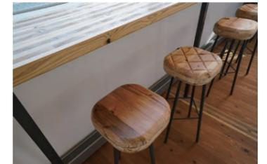
CLT削り出しにより製作したスツール
