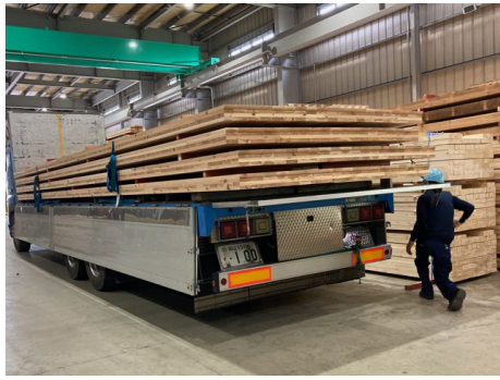
トラック積載状況
