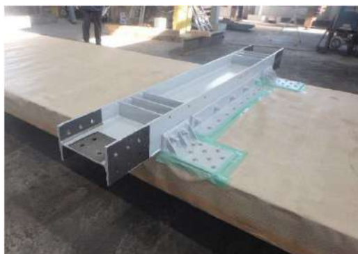
CLT と鉄骨梁のパネル化（工場製造）
