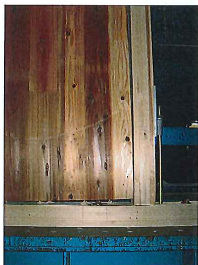
写真-15 破壊状況 番号：4 最大荷重：17.8kN
