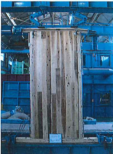
写真－1 破壊状況 番号：1 最大荷重：18.8kN
