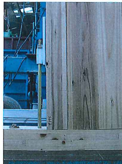
写真-7 破損状況 番号：2 最大荷重：21.0kN ・ねじの抜けによるパ ネルの浮き上がり ・座金の土台へのめり 込み
