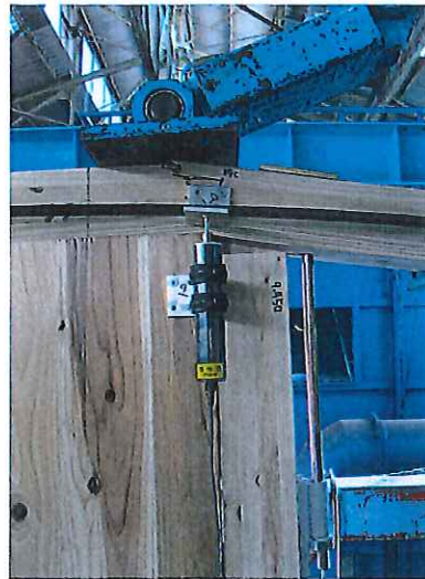
写真－2 破壊状況 番号：1 最大荷重：18.8kN
