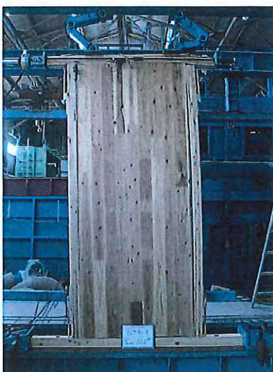
写真－5 破壊状況 番号：2 最大荷重：21.0kN
