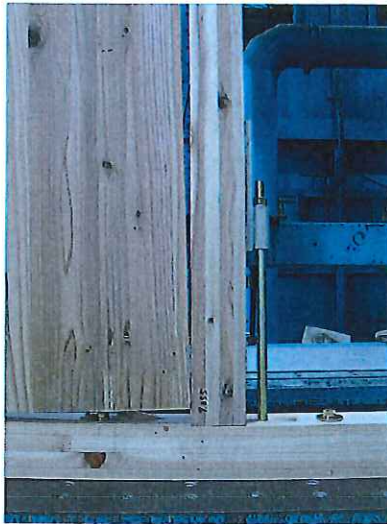
写真-7 破損状況 番号：2 最大荷重：21.0kN ・ねじの抜けによるパ ネルの浮き上がり ・座金の土台へのめり 込み
