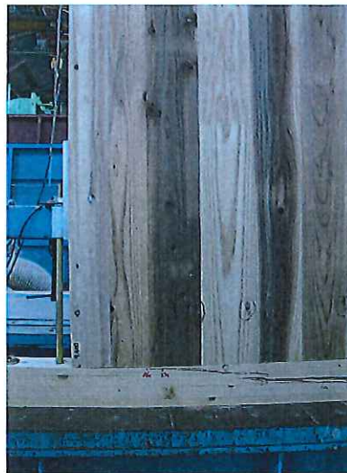
写真－4 破壊状況 番号：1 最大荷重：18.8kN
