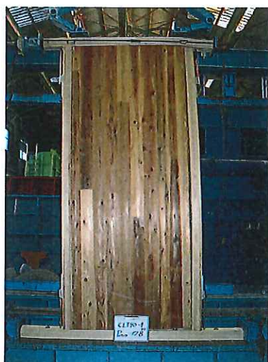
写真-13 破壊状況 番号：4 最大荷重：17.8kN
