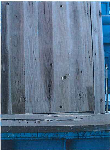
写真－3 破壊状況 番号：1 最大荷重：18.8kN
