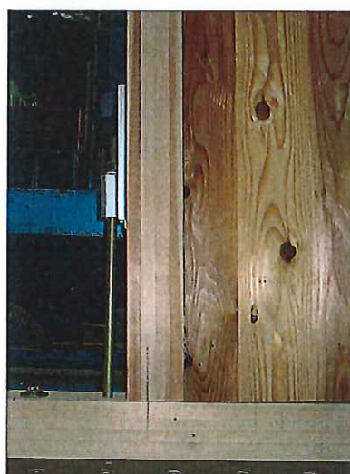
写真-16 破壊状況 番号：4 最大荷重：17.8kN
