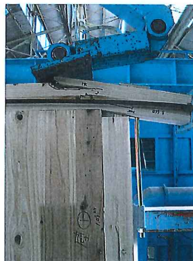
写真-10 破損状況 番号：3 最大荷重：20.7kN 梁の曲げ破損
