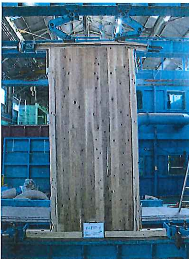
写真-9 破損状況 番号：3 最大荷重：20.7kN 全景
