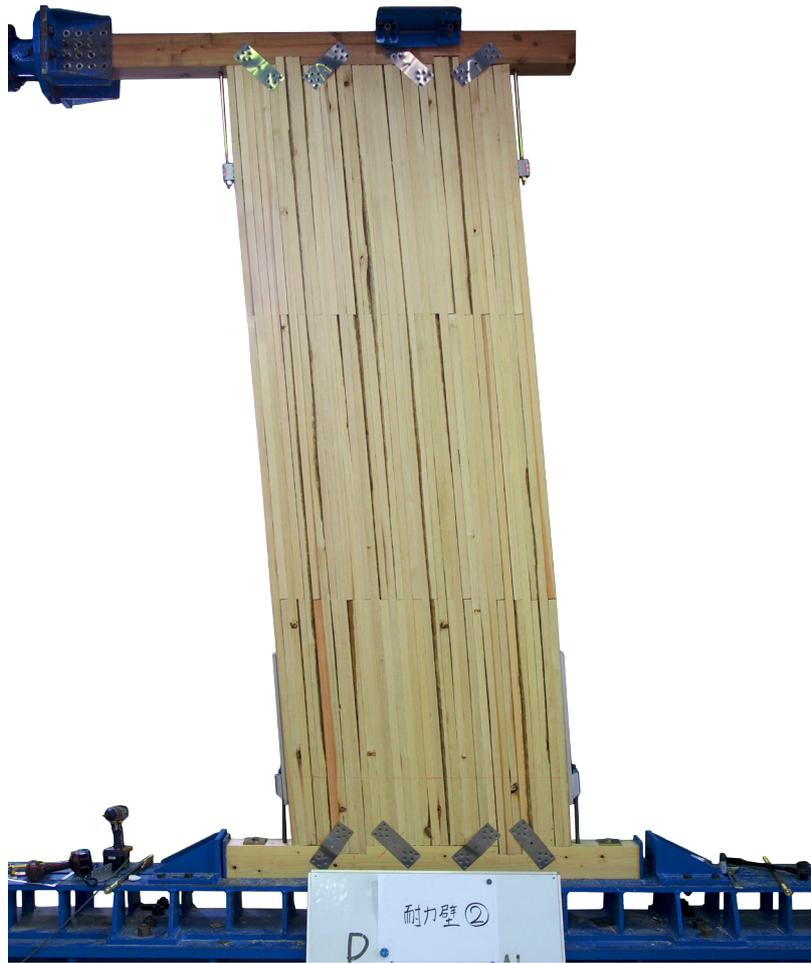
面内せん断試験(水平加力試験)
