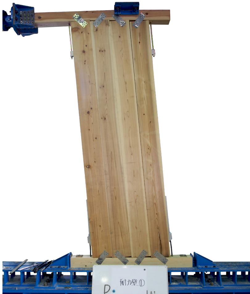
面内せん断試験(水平加力試験)
