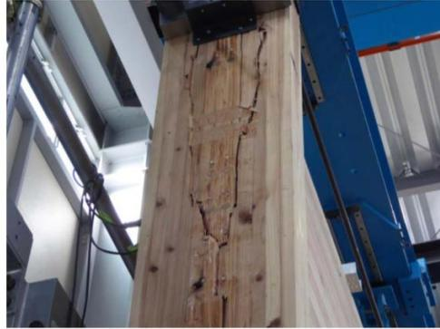
写真 3-4-3-3 TYPE.B 破壊状況
