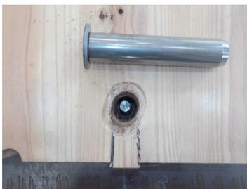
写真 22. 解体後 キャップ接合部（表面）
