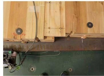
写真 18. 終局時 C L T 継ぎ目
