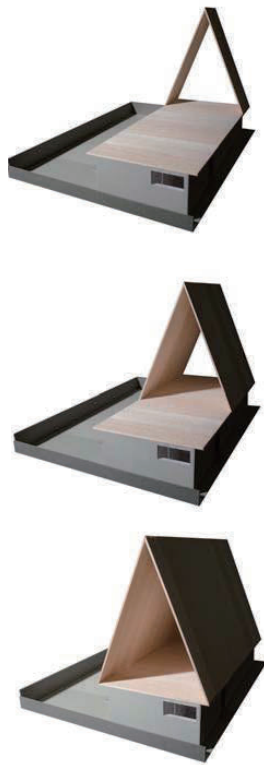
模型を用いてのCLT屋根の建方の検討
