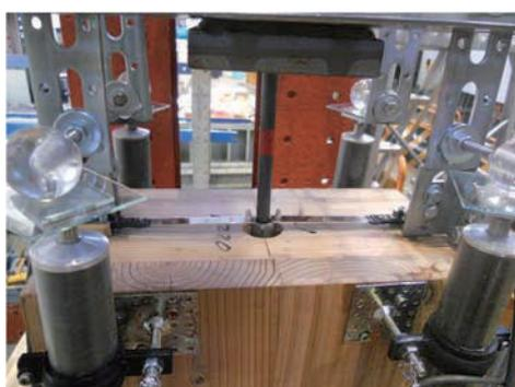
図 3-3 LSB 抜け出し変位の測定
