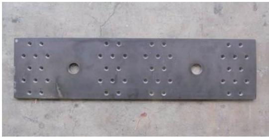
図 3-9 HTB 摩擦接合用鋼板
