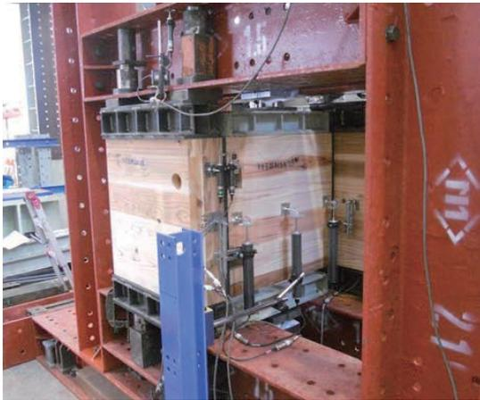
図 3-11 HTB 摩擦接合試験体セットアップ
