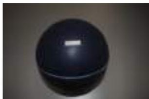
図-3.6 重量床衝撃音発生器：インパクトボール
