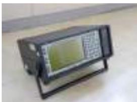
図-3.5 リアルタイムアナライザー：Dual Channel Real-time Frequency Analyzer, Type2144(Brüel & Kjær 社製)
