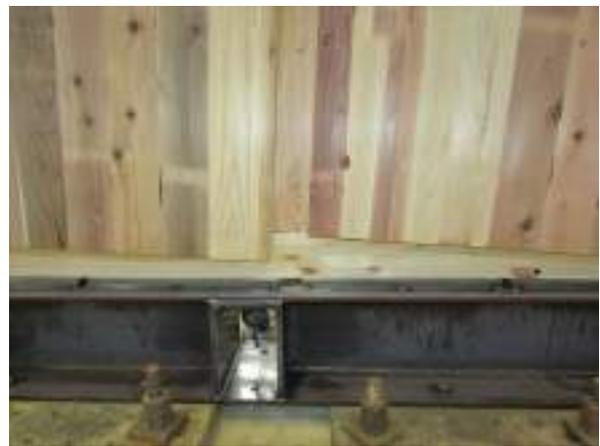
+1/15(rad) CLT パネルの回転(⑥試験体)
