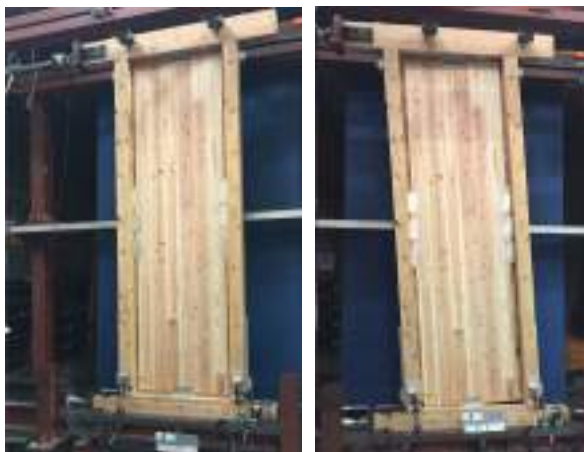
性能評価本試験(せん断試験)
