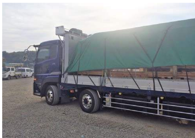
6 15tトラックでCLTパネル搬入 幅の狭いパネルは2列並べて積んだ
