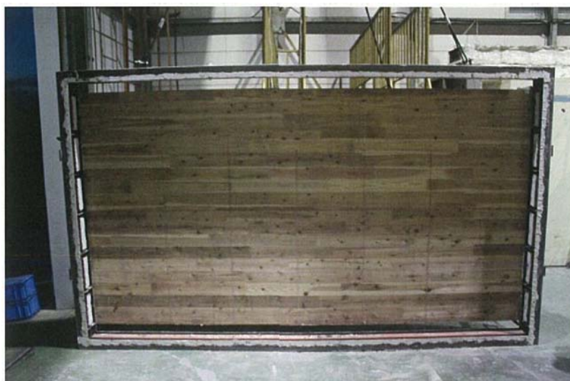
写真 試験後の荷重支持部の状況（下面加熱）
