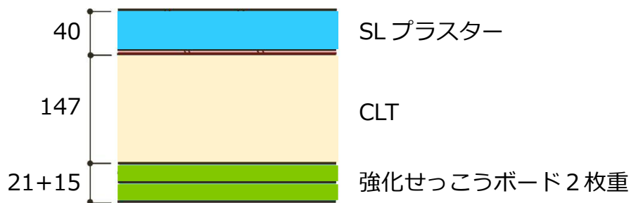
図. CLT 床耐火被覆構成図
