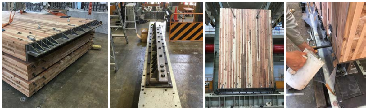
①CLTに上部 CT を取付ける ②架台に下部 CT を取付ける ③壁を載せる ④石膏で調整する
