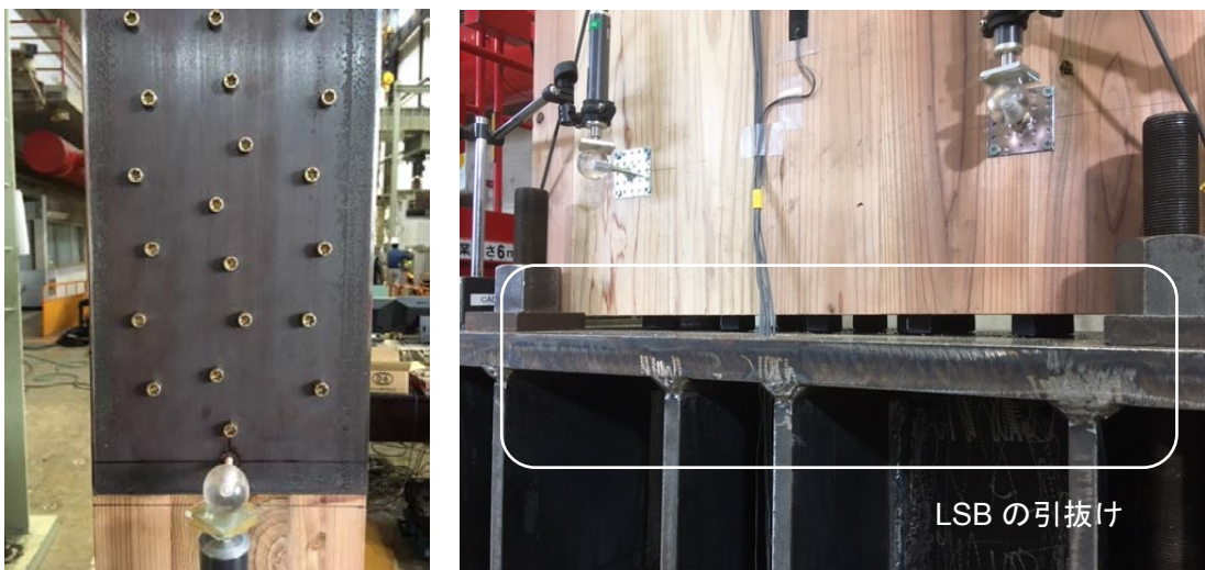
図 1.5 鋼板の変形と 59 本試験体脚部の破壊性状
