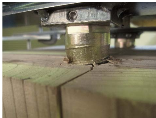
引抜けた LSB (予備試験体)
