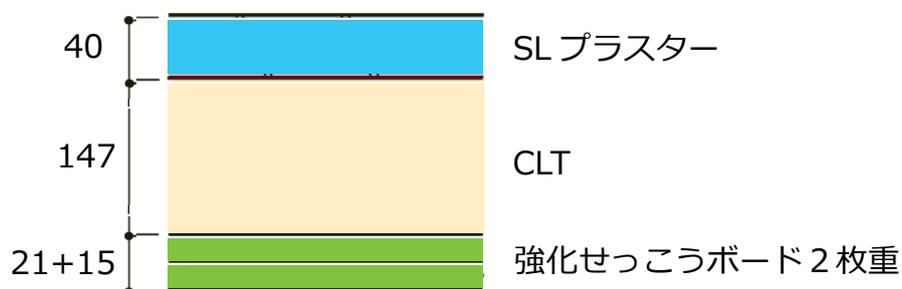
図 3.1.1 CLT 床 1 時間耐火被覆構成図
