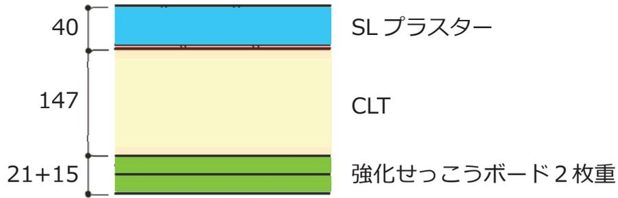
図. CLT 床耐火被覆構成図
