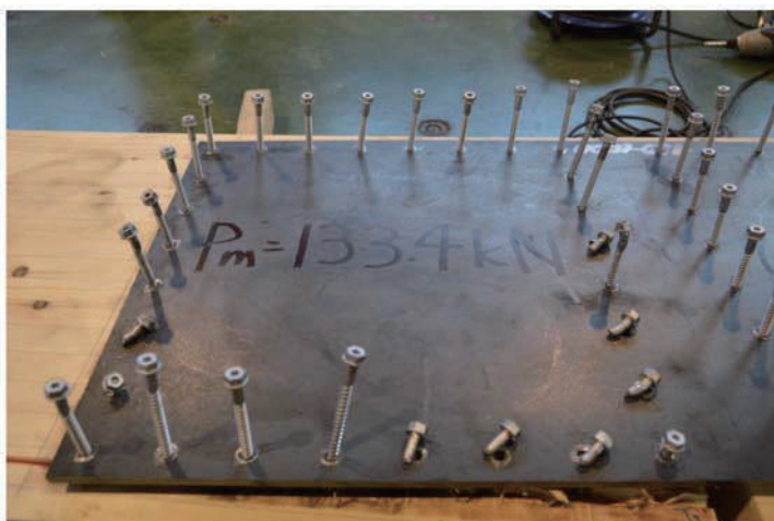
断面側部集成材接合部 ビス変形状況
