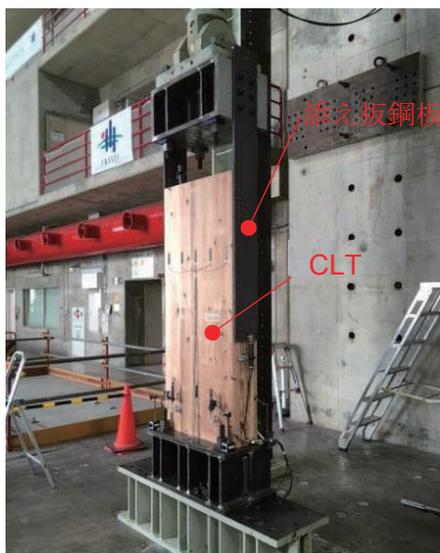
写真 2-1 肩ビス止め接合部引張実験状況
