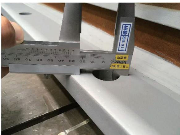
図 2-22 ボルト穴径確認（φ29 mm）
