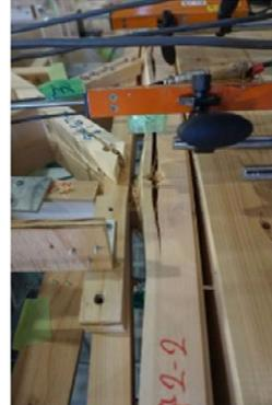
図6.3 柱脚部の破壊状況
