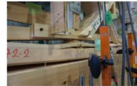
図7.4 柱脚部破壊状況
