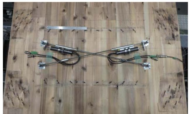
写真2 主な破壊状況(ビスのめり込み、変形)
