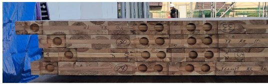
CLTパネル3層37° 厚90mm
