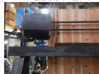
B-1 頬杖（脚部）での変形前に 加力部で CLT のめり込みが進んだ
