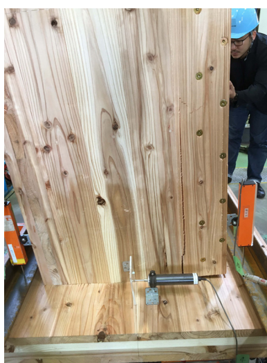
A-1 脚部 浮きと GIR 接合部分での割れ
