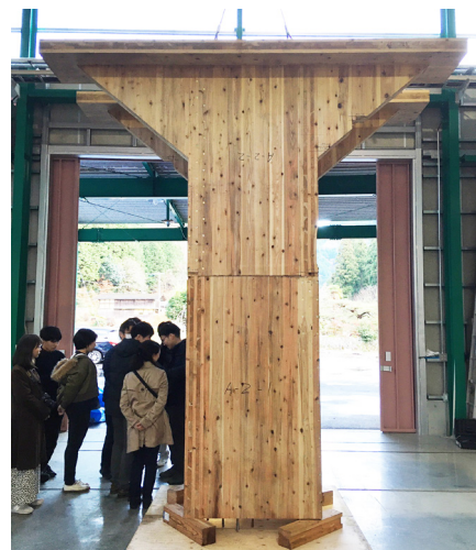
実験後に B-1・B-2 試験体を重ねて 柱型を一体として確認した様子
