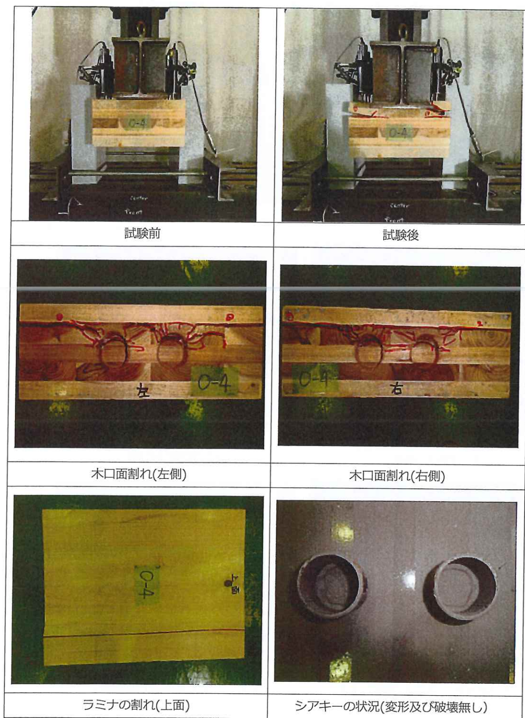
写真 6.4 破壊状況 (試験体 No.4)
