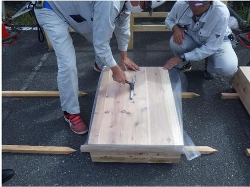
写真 試験体作成（シート張り）状況
