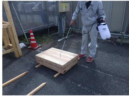
写真 試験体作成（撥水材塗布）状況
