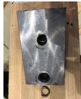
実験終了後の金物薄肉部の 破壊
