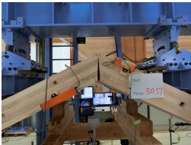
接合部の破壊状況（前側）
