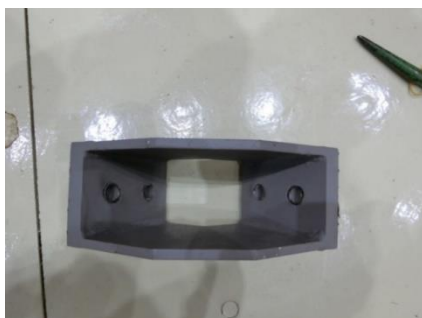
接合部の破壊状況（解体後）
