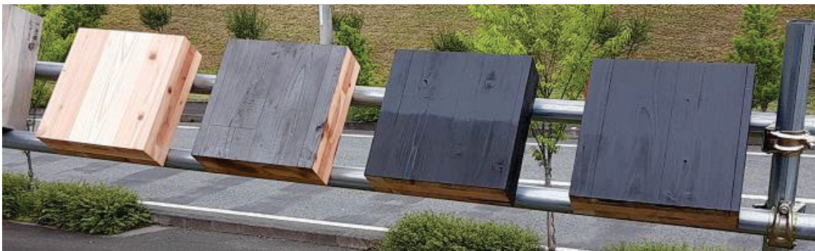
写真 3.4.2-1 左から無処理無塗装、焼杉処理無塗装、焼杉処理水性塗料塗布、焼杉処理油性塗料塗布 (塗料は、上半分を 2 回塗り、下半分を 1 回塗り)
