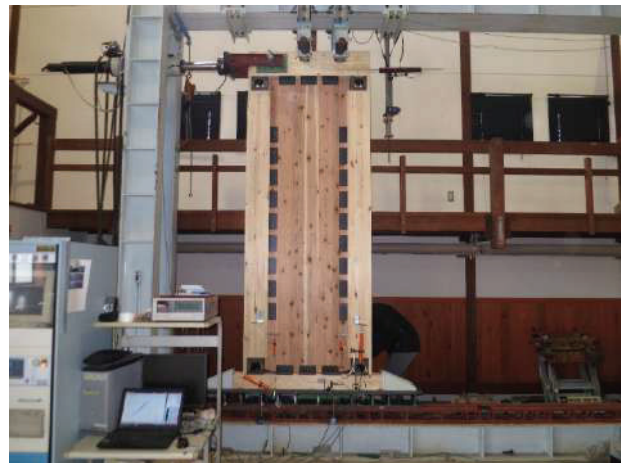
図 14 最大変形時の試験体全景 (UCLT-02)
