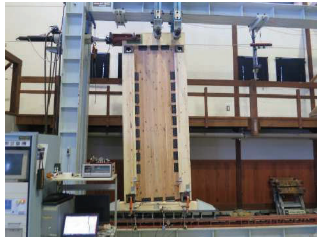
図 10 最大変形時の試験体全景 (UCLT-01)
