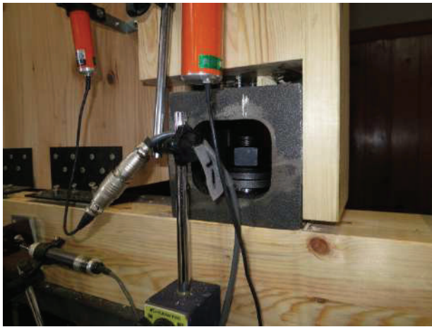
図 15 右側タフネスコネクタ引抜破壊の様子 (UCLT-02)
