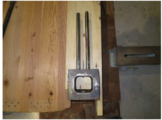
図 12 右側タフネスコネクタの破断の様子 (UCLT-01)
