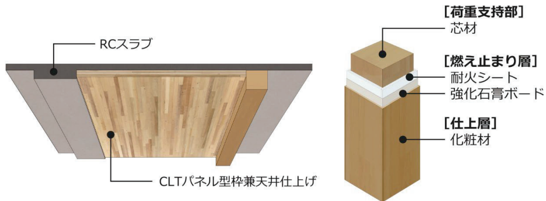
図 8-2. RC・CLT 合成床板、耐火集成材概要図
