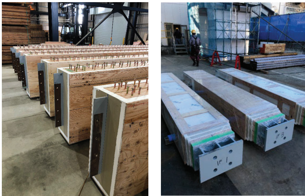
図 8-5-1-2. 耐火集成材 工場施工・養生状況
