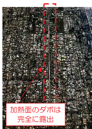
図 5.2 燃焼試験後のダボの様子
