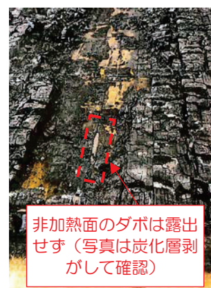
図 5.2 燃焼試験後のダボの様子
