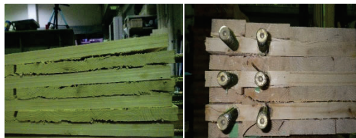
写真 3.1.2 試験 I GCT-a (トドマツ) の破壊性状
