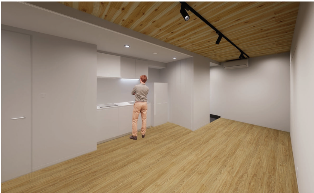
図) 内観レンダリングパース：CLT 現し部の見え方について照明効果をシミュレーション
