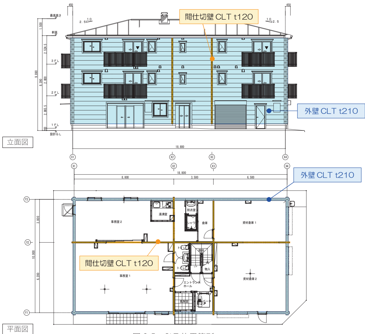
図 2-5 CLT 使用箇所
