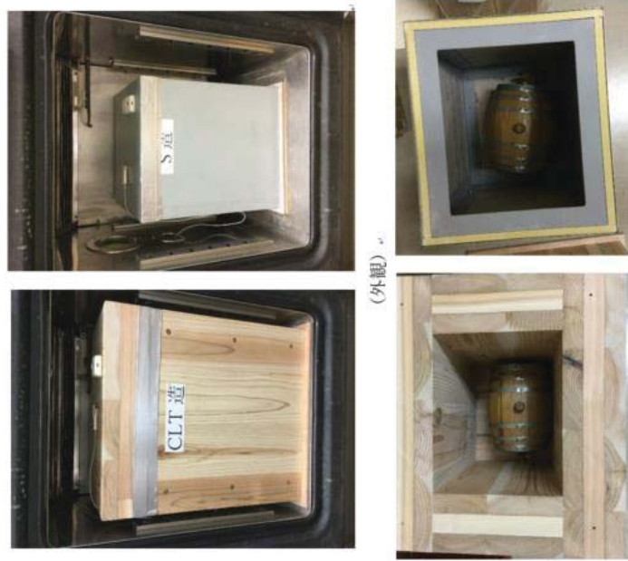
写真1 小型熟成庫モデル (左: CLT、右: スレート)
