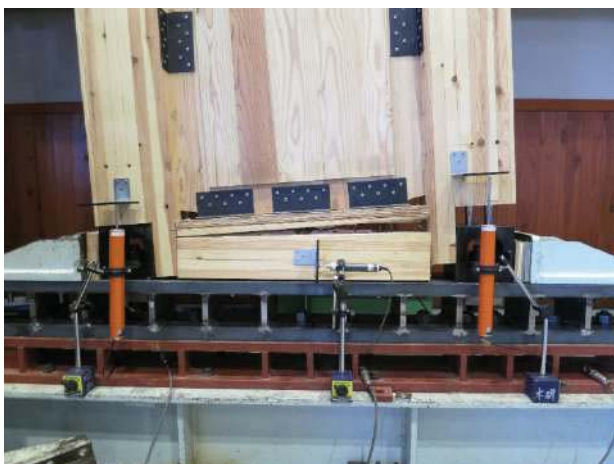
図 2 3 右側タフネスコネクタ引抜破壊の様子
