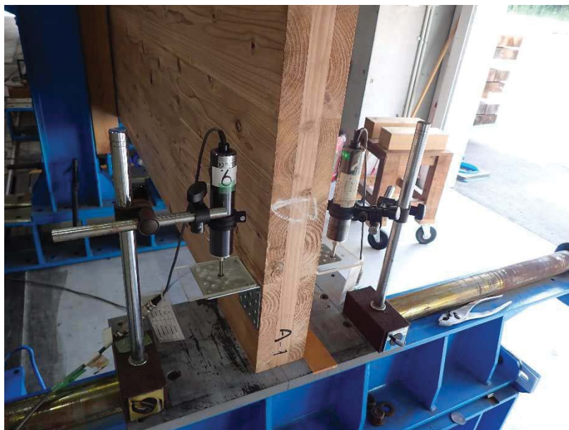
写真 2.4 変位計測状況（支持点）
