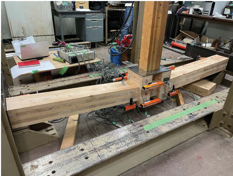
図 接合部引張試験 試験全景
