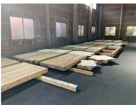
写真13 耐火被覆取付（工場）
