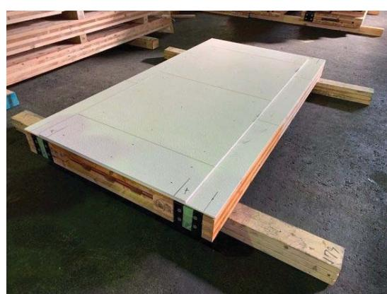
写真14 C L Tパネル化
