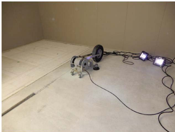
写真 3-3 RC 合成デッキ床標準重量衝撃音源および軽量衝撃音源設置状況
