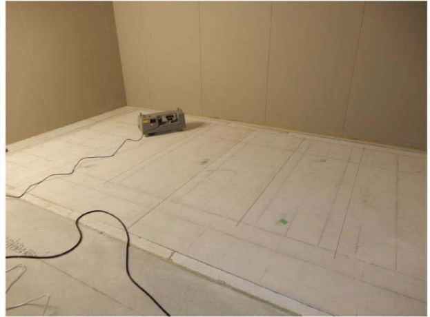
写真 3-2 CLT 床標準重量衝撃音源および軽量衝撃音源設置状況
