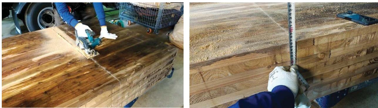
写真 2-9 丸ノコ切断状況
