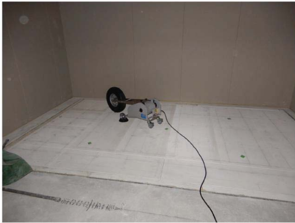
写真 3-2 CLT 床標準重量衝撃音源および軽量衝撃音源設置状況
