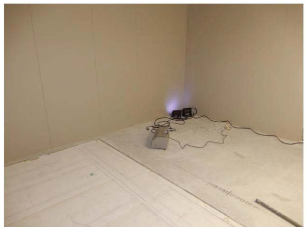
写真 3-3 RC 合成デッキ床標準重量衝撃音源および軽量衝撃音源設置状況
