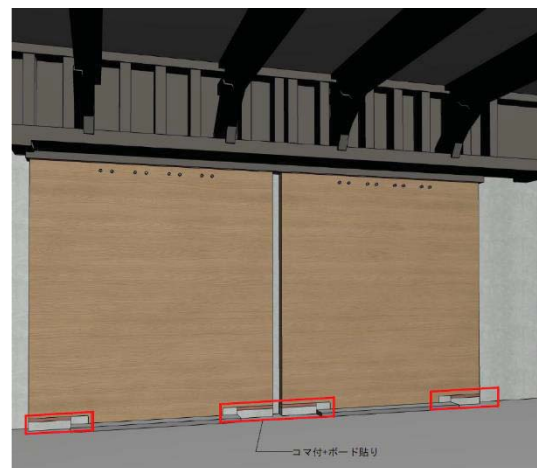
⑩支圧プレート下部コマ付け+ボード貼り
