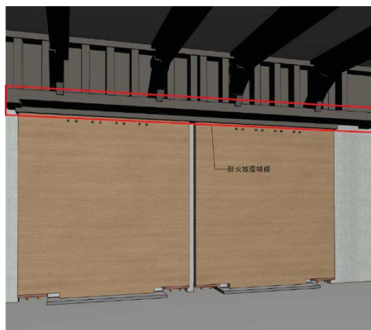
⑨耐火被覆補修
