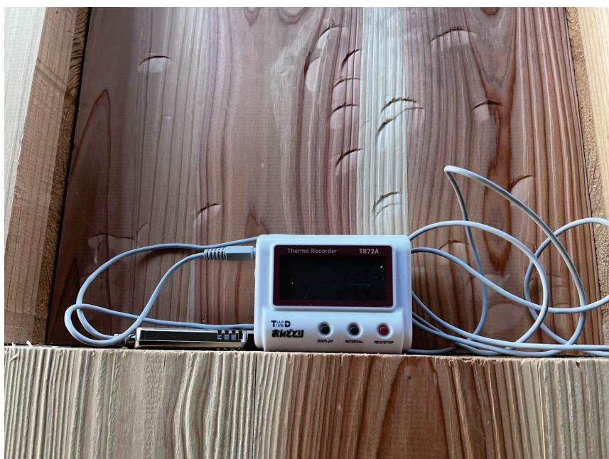
データロガー設置写真（断熱施工前）
