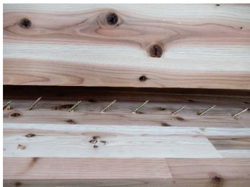
(b) 下フランジのビス抜け
