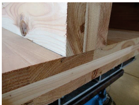
(b) スラブ端部でのせん断ずれ
