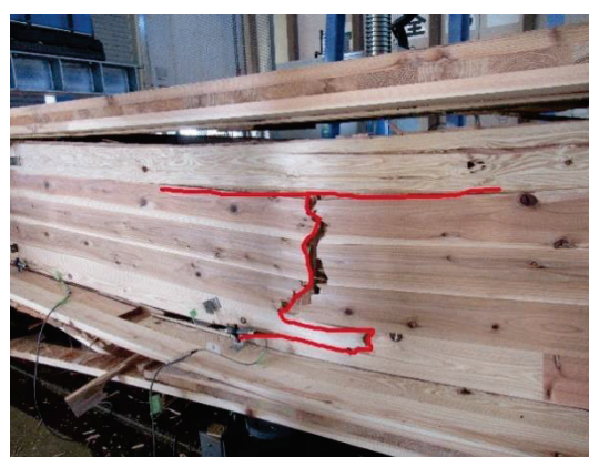
(c) ウェブ材の面内曲げ破壊
