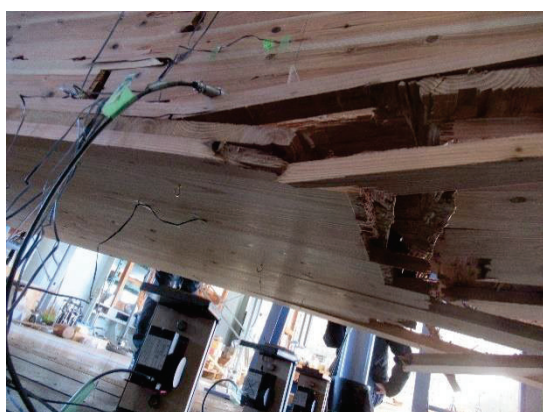
(b) 下フランジのビス抜け
