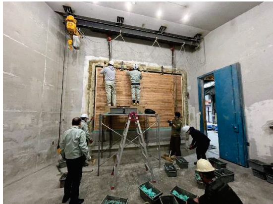
写真 3-8 試験体の設置
