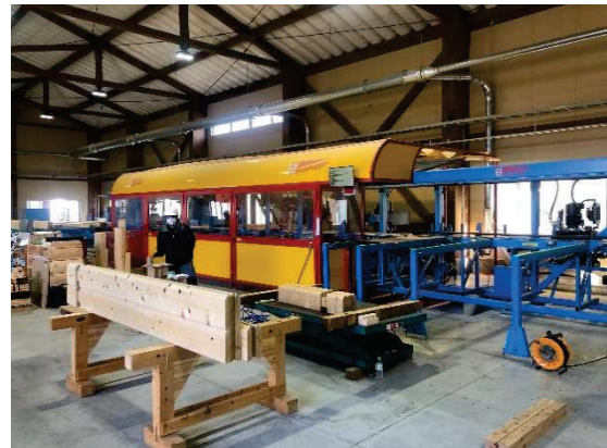
写真 5-2 CLT ログ加工機
