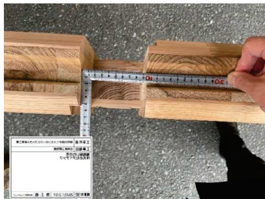
写真 4-4 工場出荷検査
