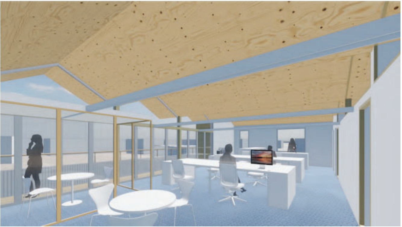
[内観イメージ] CLT折接屋根があらわしになることで、木を感じられる居住性の高い執務空間となる
