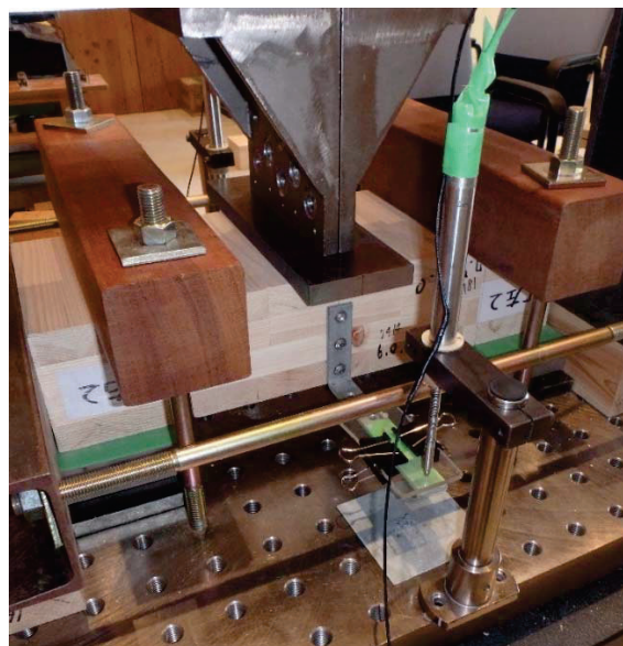
写真 2.2 試験状況（引抜き試験）
