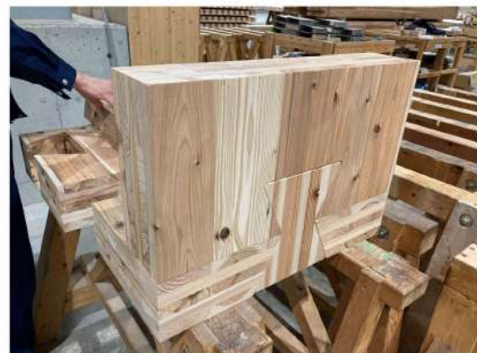
高耐力CCU 蝶蟻部組立 要素試作実験 (SAI開発/ミヨシ加工) R8
