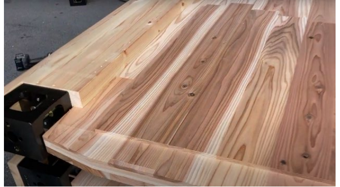
図6 柱と CLT の接着後の様子
