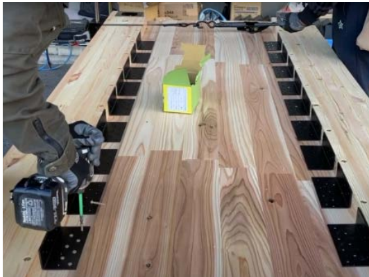
図1 工場施工型 CLT 耐力壁パネル製作工程
