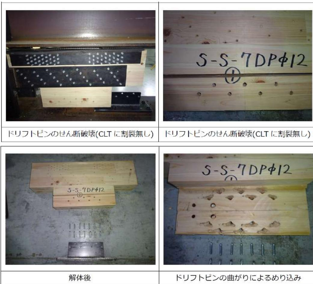
写真：接合部破壊状況（弱軸方向）
