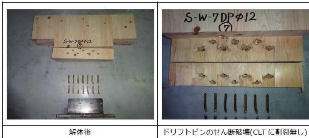
写真：接合部破壊状況（弱軸方向）
